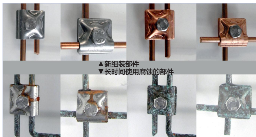
图3：新部件产品和长时间使用后的对比
