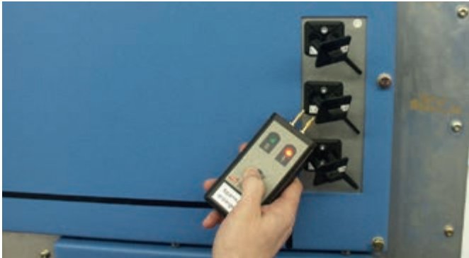
DEHNcap / A电压指示器进行自测
