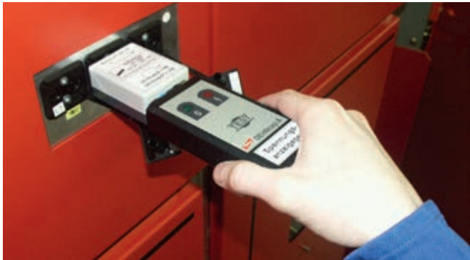
HR-LRM测试适配器可适用于HR测试插孔的LRM指示器
