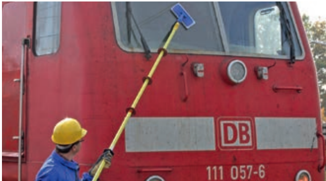
用于电力机车挡风玻璃清洁的绝缘棒套件
