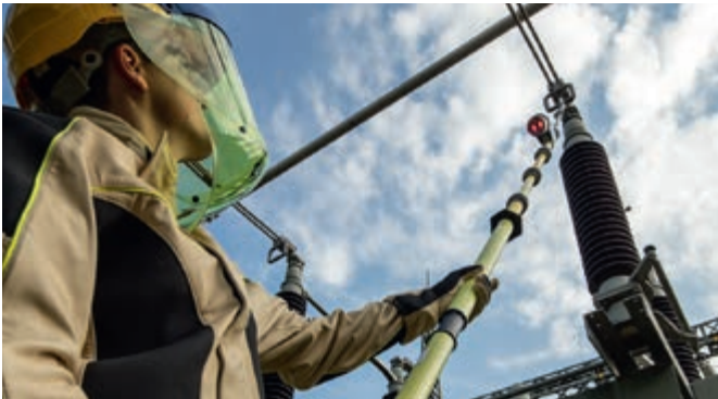
PHE4电压探测器应用在110 kV户外开关设备
