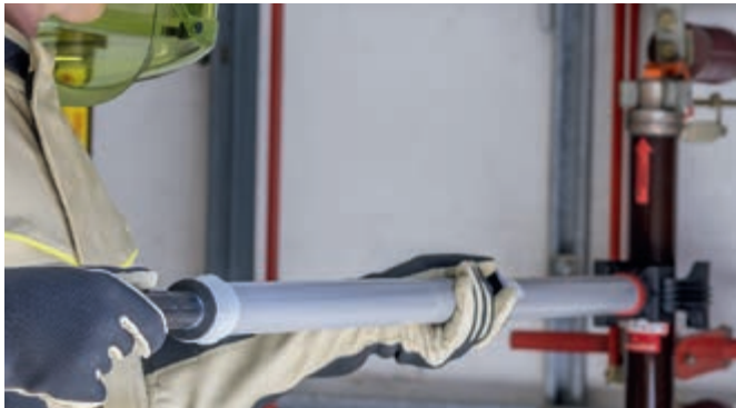
SZ熔丝钳用于装入或者移除 HH 熔丝
