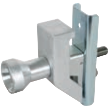
用于母排的固定夹持配件 带有母线固定元件的固定夹持配件，夹持母线厚度可达25 mm，带有接触爪匹配短路排的纵向槽
