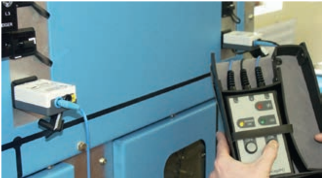
DEHNcap / PC-LRM相位比较器带两个HR-LRM测试头，是用在HR 开关设备内
