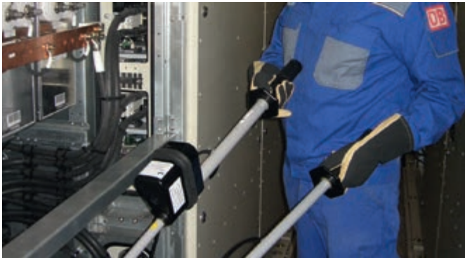
PHE / G II直流电压探测器，用于直流供电装置（ICE操作端）
