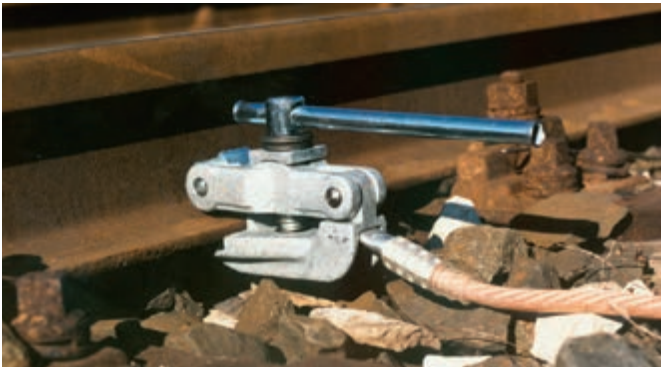
用于在铁轨上固定的夹具
