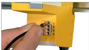
直插技术确保导线轻松连接无需工具
