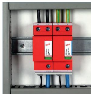
产品的工作状态/故障指示无需电源供电，实时给出产品工作状态信息。除了可视化的红/绿实时状态指示，DEHNbloc M ... FM系列产品还提供了具有浮动切换触点的遥信端子。可根据监控电路定义的不同，选择使用常开或者常闭触点。
