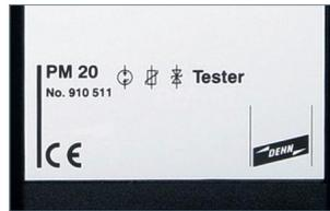
气体放电管，压敏电阻和二极管的响应特性均可测出
