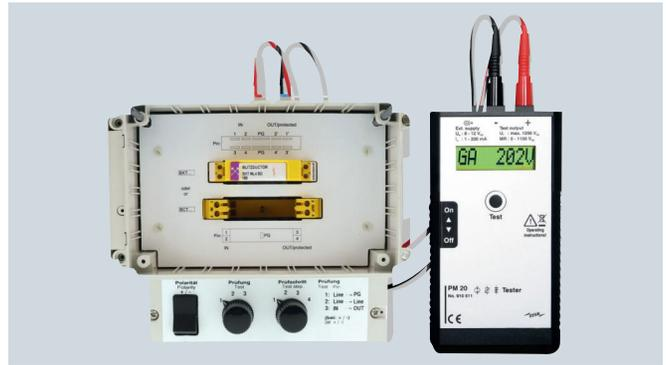
用于测试电涌保护器的启动电压。被测样品需连接测试线或特殊的测试适配器
