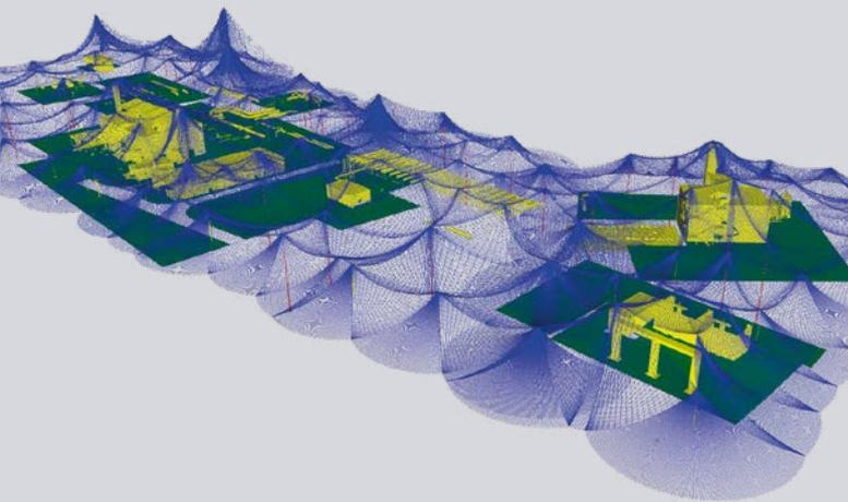
2 进行3D防雷设计并创建最终方案-压缩机的保护效果展示
