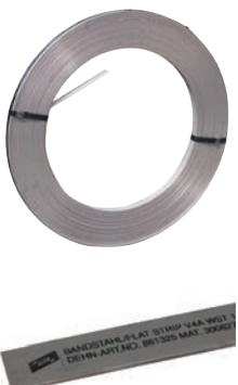
其中表面带有油墨标签印刷的不锈钢扁带, 以每米为单位增量印刷。根据EN 62561-2和IEC / EN62305-3,DIN18014及DIN VDE 0151相关标准, 在土壤地下使用不锈钢扁带必须采用不锈钢 (V4A)材料, 并且其钼含量为≥2%, 如1.4571, 1.4404。
