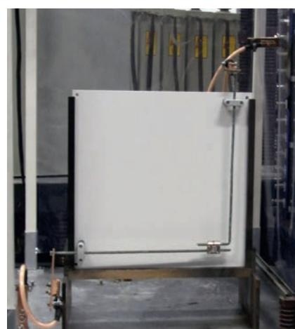
图5：在冲击电流试验室中，固定在绝缘板（MV夹具）上的样品
