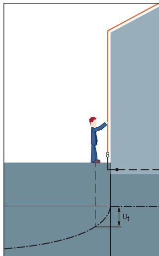
图1：接触电压原理图
