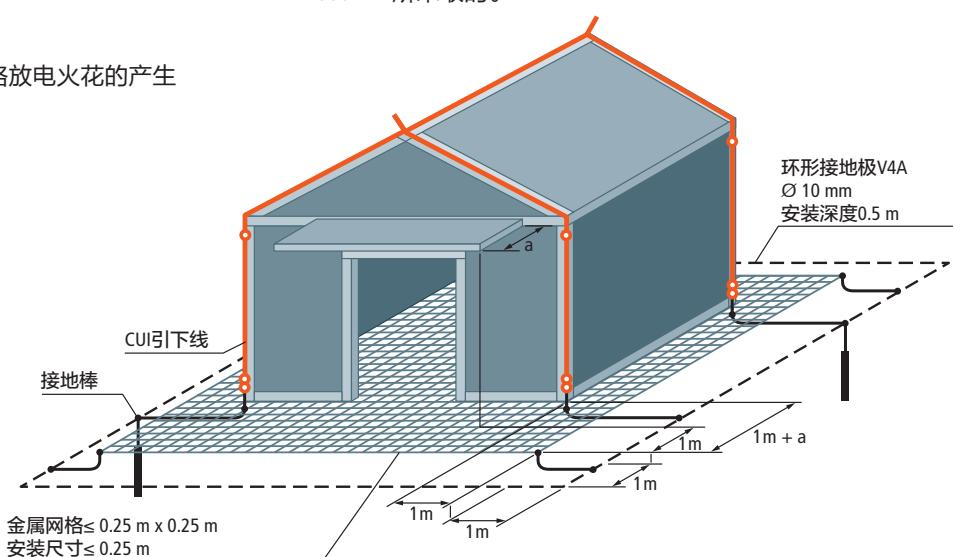
接触电压的防护
