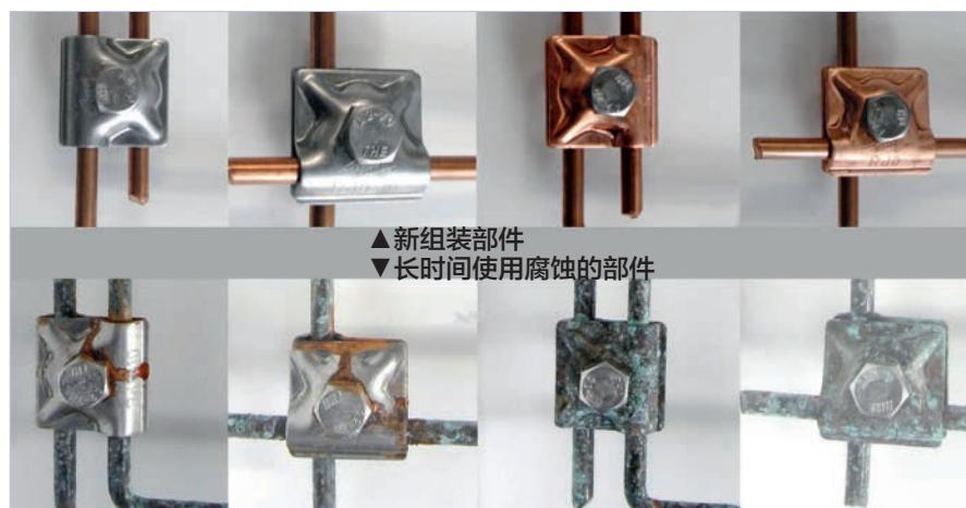
图3：新部件产品和长时间使用后的对比
