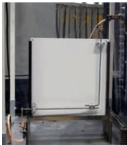
图5：在冲击电流试验室中，固定在绝缘板（MV夹具）上的样品
