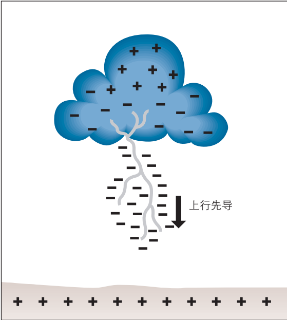
图2.1.2 带负电荷的下行先导的放电机理 (云对地放电)
