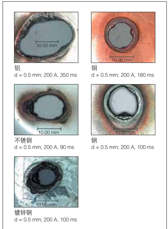
图2.4.3 由于长持续时间电弧的作用, 使金属薄板穿孔
