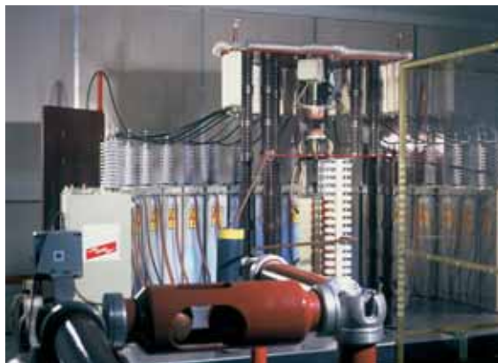
图 9.16.1 德和盛公司 ( DEHN + SÖHNE ) 的冲击电流实验室 - 最大的雷电冲击电流是200 kA，波形为10/350 \mu s
