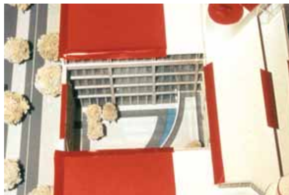
图 5.1.1.5 新建的DAS的行政大楼：保护等级为I级时的雷击危险区域，俯视图(截图) 来源：WBG 维辛格
