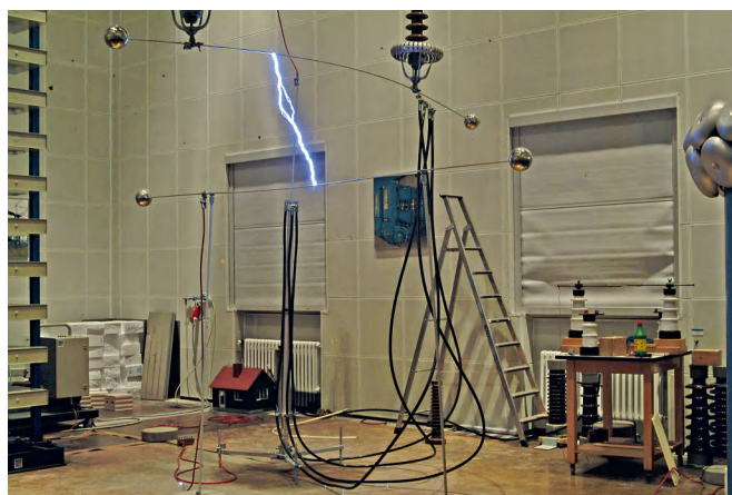
图6：根据标准 IEC TS 62561-2 版1.0 2018-01，带有4根HVI导线的一套HVI系统高压测试
