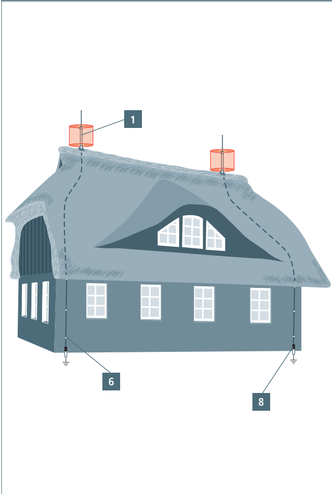
HVI引下线在茅草屋顶的安装保护应用
