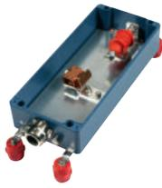
同轴接线箱用于 EXFS100火花间隙的同轴（低阻抗）连接，以保护绝缘接头或法兰，安装在防爆区域之外的地面上，因此易于维护和检测。 | NAK SN4631  | 999 990 |
